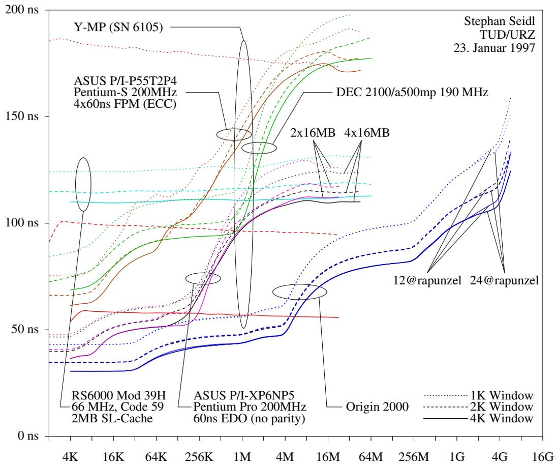
Zeit für die Ausführung einer Elementaroperation, bestehend aus schreibendem FP-Vorzeichenwechsel, FP-Multiplikation, FP-Addition und Overhead, in Abhängigkeit von der "Lage" des Objekt-Feldes (Window) innerhalb des Speichers.
